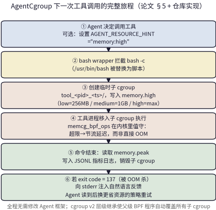
示意图 D5：一次工具调用的资源控制生命周期——wrapper 拦截、子 cgroup 创建、eBPF 内核态执行、意图反馈闭环。
